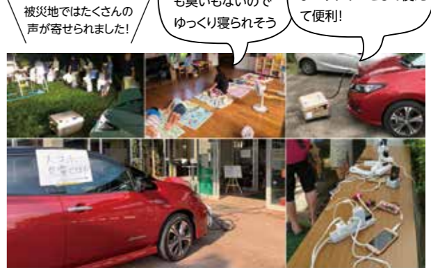
写真上段左:灯光器の電源に使用/上段中央:保育園で扇風機の電源に使用/上段右と下段左:日産リーフから電気を取り出しているようす/下段右:日産リーフの電気でスマートフォン充電中
